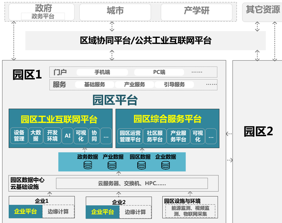
图3 工业互联网园区平台架构
