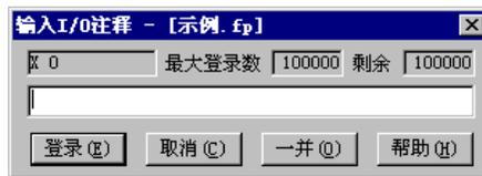
在触点监控窗口中的④注释显示列处按 **[Enter]** 键、或用鼠标双击，则画面将显示如左图所示的注释输入对话框。
