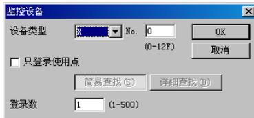
在触点监控窗口的①(行编号显示列)或②(登录设备显示列)处按[Enter]键、或鼠标双击，将显示监控设备对话框。
