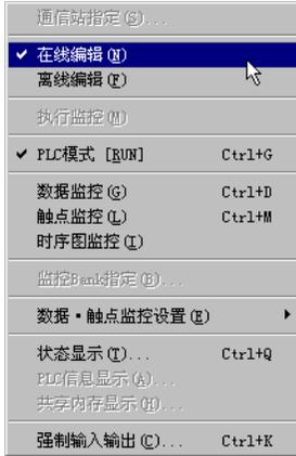
请将正在运行 FPWIN GR 的计算机通过指定的编程电缆与 PLC 相连，然后选择 FPWIN GR 的[在线(L)]菜单中的[在线编辑(N)]。
