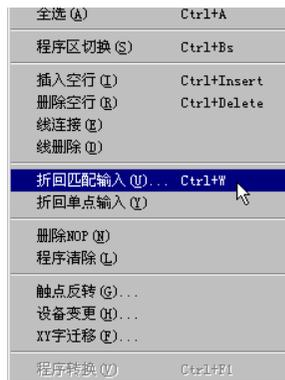
进行折回匹配输入时,请通过菜单操作选择[编辑(E)]→[折回匹配输入]。
