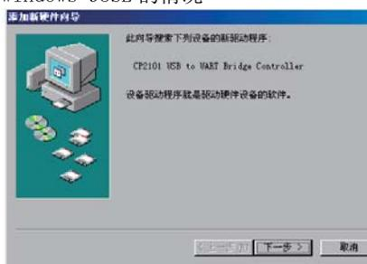
在安装 FPWIN GR Ver.2.5 以上的版本之前的状态的情况下，即使显示上述画面，也请务必点击[取消]按钮、停止安装。
