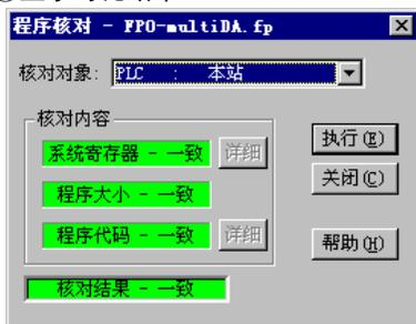
核对结束后，将显示对照比较的结果。
