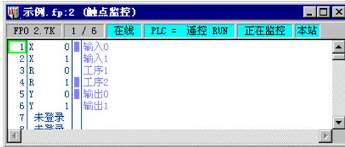
设置作为监控对象的设备、在在线编辑方式下开始监控后，各触点或线圈的ON/OFF状态将被显示在触点监控窗口③(监控显示列)中。
