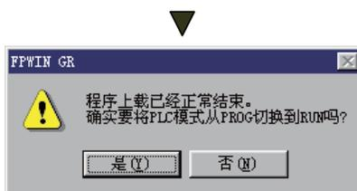
开始进行程序上载,并且在正常结束后,画面中会显示关于确认 PLC 模式变更的对话框。
