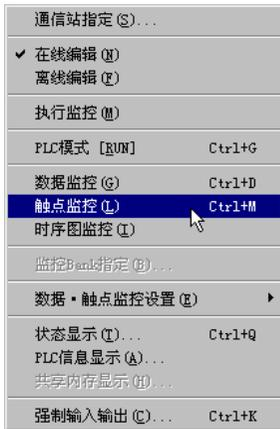
进行触点监控开始操作时，请利用菜单栏中的[在线(L)]→[触点监控(L)]。
