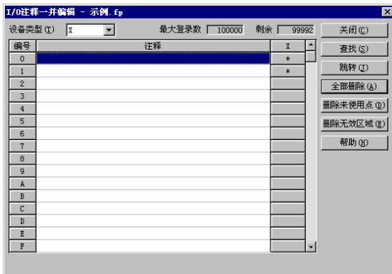
选择[I/O注释一并编辑(E)]后，画面中将显示如左图所示的对话框。
