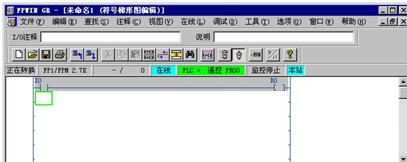
进行程序转换时，请用鼠标点击[功能键栏]中的 **PG转换**，或按 **CTRL+F1** 键。在反显的状态下也可以编写及修改程序，但在编程工作结束后，集中进行程序转换。
