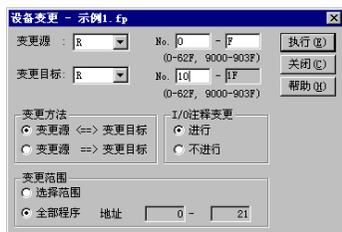
如左图所示，按照[变更源：R0~RF]、[变更目标：R10~R1F]进行设置，再单击[执行(E)]按钮，则以下所示的程序中，R0~RF被修改为R10~R1F。
