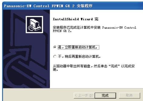
全部安装工作完成后,画面中将显示关于确认重新启动计算机的对话框,请用单选按钮选择[是,立即重新启动计算机]或[不,稍后再重新启动计算机],然后再单击[完成]按钮。
