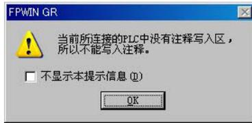
当程序接收方的 PLC 中没有注释写入存储区时,画面将显示左图所示的对话框。
