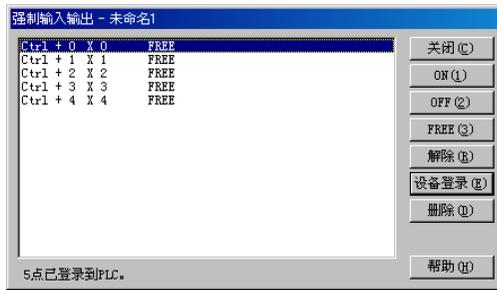
选择需要强制输入输出的设备(反显)并单击[ON(1)]按钮后, 所选择的设备与程序无关地将被强制置为 ON, 如果单击[OFF(2)]则该设备被置为 OFF。
