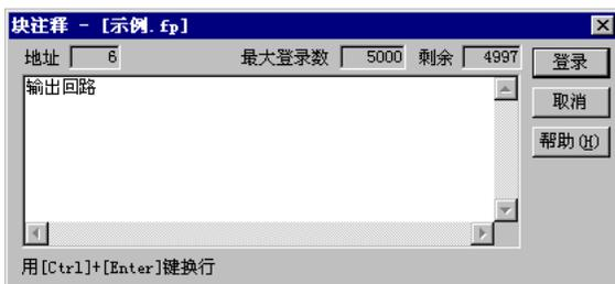
选择[块注释输入(B)]后,画面将会显示如左图所示的对话框。请在输入窗口中输入说明文字,然后按[ENTER]键结束输入。
