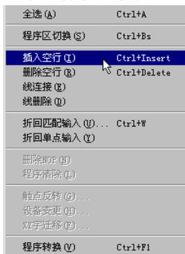
执行空行插入操作输入时，请利用菜单操作选择[编辑(E)]→[输入空行(I)]。
