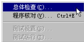
进行程序全部检查时，请利用菜单操作选择[调试(D)]→[程序总体检查(C)]。
