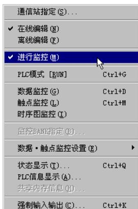
进行监控开始操作时，请利用菜单栏中的[在线(L)]，然后点击所显示的菜单中的[执行监控(M)]一项，使其带有选中标记“√”。
