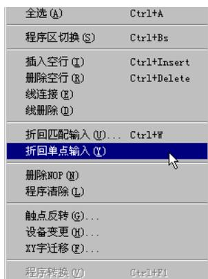
进行折回单点输入时，请通过菜单操作选择[编辑(E)]→[折回单点输入]。
