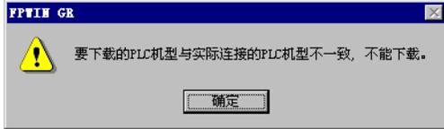
下载程序时, 如果出现如左图所示的信息, 则表明所选择的 PLC 机型有误, 请进行[机型转换]操作。
