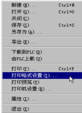
设置打印格式时，请利用菜单操作选择[文件(F)]→[打印格式设置(Y)]。
