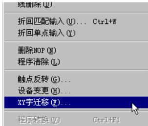
进行 XY 字迁移操作时,请利用菜单操作选择[编辑(E)]→[XY 字迁移]。
