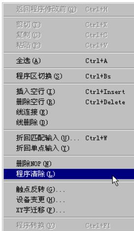
请先确认是否已处于在线编辑方式，然后再选择[编辑(E)]菜单中的[程序清除(C)]。
