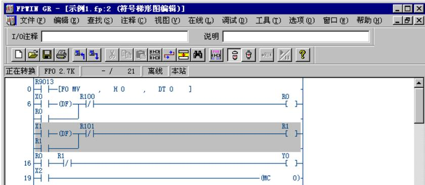
进行程序转换时，请用鼠标点击[功能键栏] **PG转换** ，或者按 **CTRL+F1** 键。但是即使在反显状态下，生成或编辑程序也最多只能进行 33 行的处理，因此在这种情况下，请在程序作业结束后集中进行程序转换。
