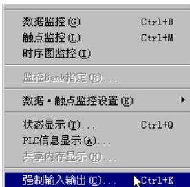
进行强制输入输出操作时,请利用菜单栏选择[在线(L)]→[强制输入输出(L)]。
