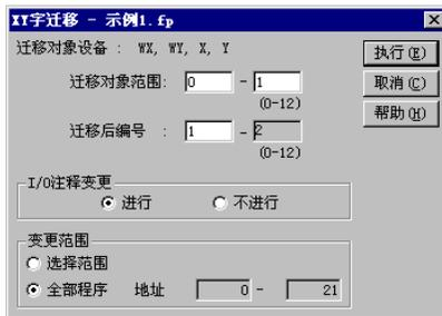
如左图所示,按照[迁移对象范围: 0-1]、[迁移后编号: 1-2]进行设置,再单击[执行(E)]按钮,则如下所示, X0~X1F 被迁移到 X10~X2F, Y0~Y1F 被迁移到 Y10~Y2F。
