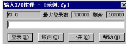
在数据监控窗口中的⑤(注释显示列)处按[Enter]键、或用鼠标双击，则将显示如左图所示的 I/O 注释输入对话框。
