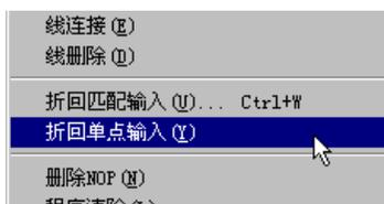
进行折回单点输入时，请通过菜单操作选择[编辑(E)]→[折回单点输入]。
