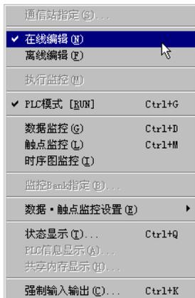
在线编辑与离线编辑的切换，可以用鼠标点击菜单栏中的[在线(L)]或用 ALT+L 键操作在菜单中所显示的[在线编辑]与[离线编辑]之间进行切换。
