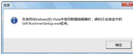
在 Windows Vista®或 Windows® 7 中使用数据编辑器时,必须登录 Visual Basic 的 Runtime,因此请务必在安装完成之后执行安装盘内的 VB Runtime\Setup.exe。
