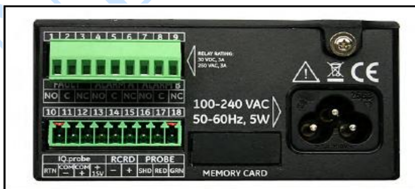
图 27 仪表后端接线插头
