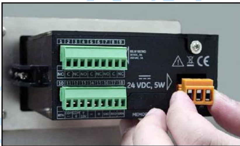
图 32 拆下 DC 电源仪表端子头
