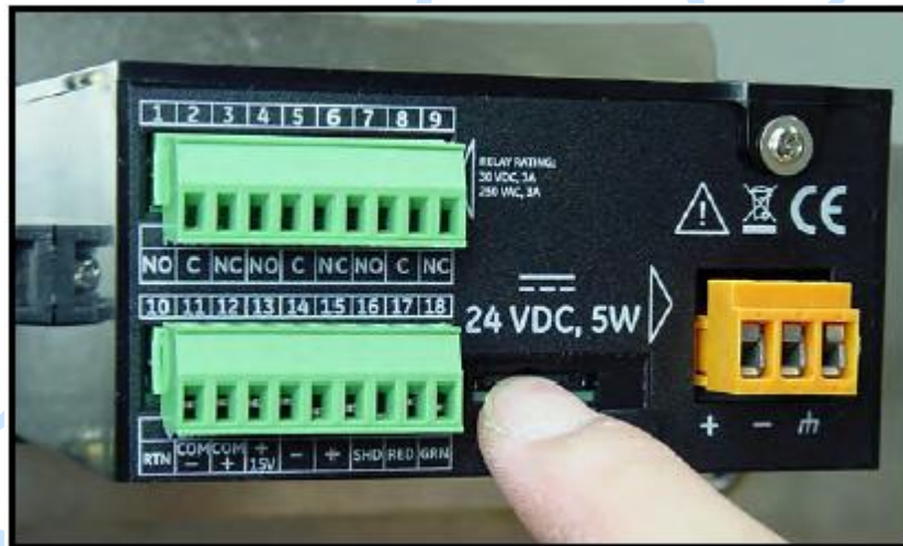
图 49 向内推 SD 卡，卡自动弹出
