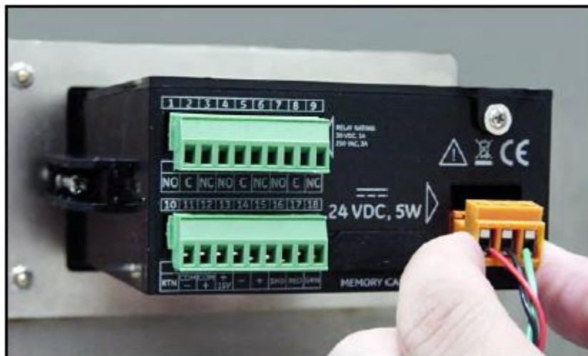
图 33 插回 DC 电源仪表端子头
