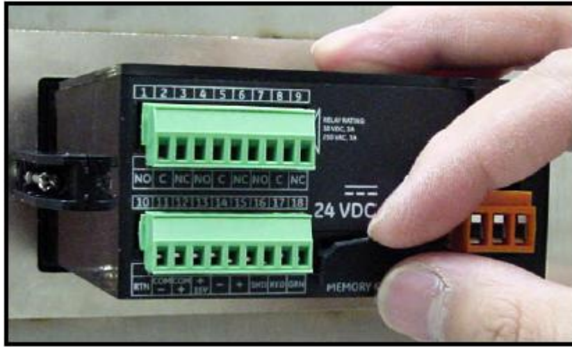
图 48 取下仪表后面板 SD 卡槽后盖
