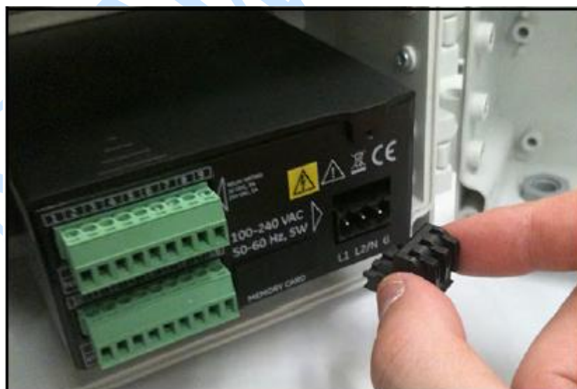
图 32 拆下 AC 电源仪表端子头
