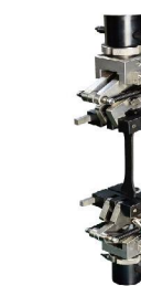
杠杆拉伸夹具 最大力5kN
