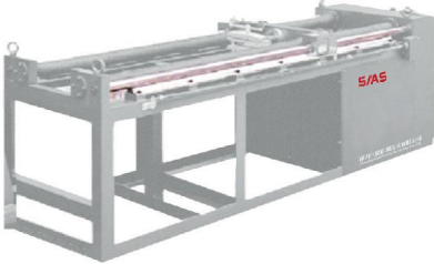
卧式拉力试验机 (10-300) kN 0.5级
