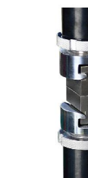
粘接强度拉伸夹具 最大力5kN
