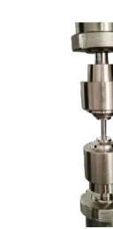
挂式拉伸夹具 最大力5kN
