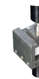
粘接强度拉伸夹具 最大力5kN
