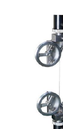
线绳缠绕拉伸夹具 最大力10kN
