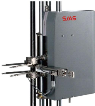
全自动引伸计, 0.5级 轴向标距10-200, 变形0-100 径向标距5-50, 变形0-10
