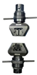
楔形拉伸夹具 最大力 300kN
