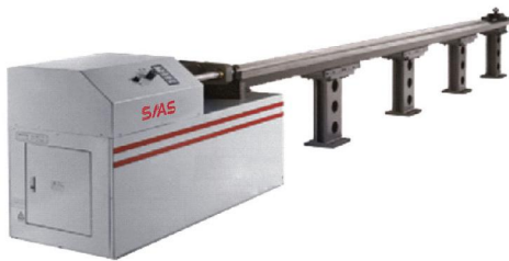
卧式拉力试验机 (10-300) kN 0.5级
