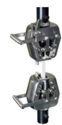
高低温楔形拉伸夹具 最大力20kN
