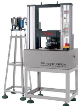
冶金球团抗压全自动试验机 (10-50) kN 0.5级
