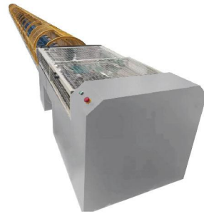
卧式拉力试验机 (10-300) kN 0.5级
