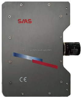
视频引伸计, 0.5级/ B-1 轴向标距10-200, 变形0-80; 径向标距5-50, 变形0-10 适应温度: -70°C~~1600°C 采样频率: 0~500Hz
