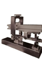
断裂韧性试验 ASTM.D6671
