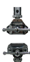
宽带对夹拉伸夹具 最大力20kN
