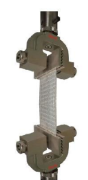
对夹拉伸夹具 最大力5kN
