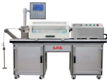
线材扭转试验机 (0.3-10) mm
