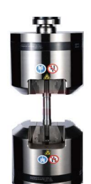
液压楔形拉伸夹具 最大力1000kN
