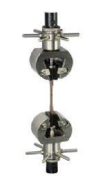
高低温楔形拉伸夹具 最大力30kN
