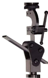
浮动辊剥离夹具 ASTM D3167
