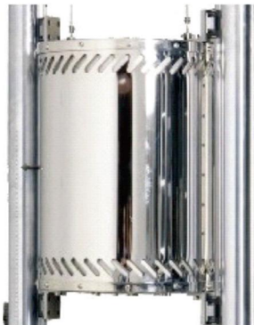
筒式高温炉, ø1.2、ø5炉丝 温度300°C-1100°C、300°C-1300°C 均温带200mm
