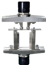
四点弯曲夹具 最大力100kN
