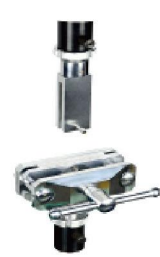
土工布钉杆撕裂 拉伸夹具 最大力1kN
