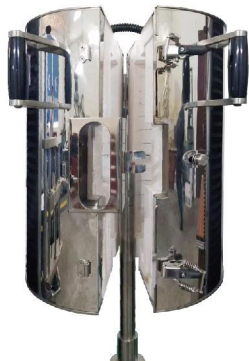
对开式高温炉, ø1.2炉丝 温度300°C-1100°C 均温带150mm, 带玻璃视窗
