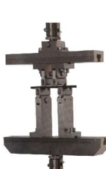
四点弯曲夹具 ASTM D7264, ASTM D6272, ISO14125
