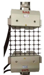
土工布气动对夹 拉伸夹具 最大力50kN
