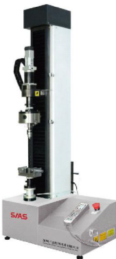
接骨螺钉拉扭扭试验机 0-50Nm/0-10kN 0.5级
