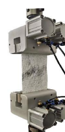
气动对夹夹具 最大力5kN
