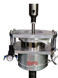
土工布气动顶破 刺破夹具 最大力50kN
