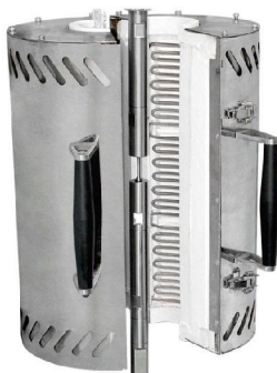
对开式高温炉, ø5炉丝 温度300°C-1300°C 均温带200mm
