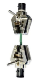
楔形拉伸夹具 最大力20kN
