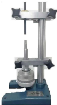
引伸计标距仪, 0.1级 测量标距10-600 测量变形0-30
