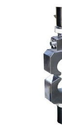
八字模粘接拉伸夹具 最大力10kN
