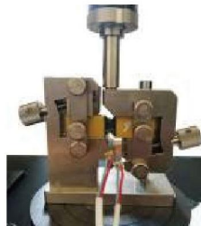
平面剪切夹具(V型轨道) ASTMD5379
