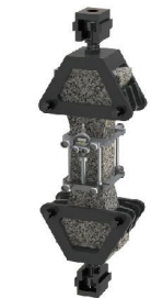
混凝土极限拉伸夹具 最大力200kN
