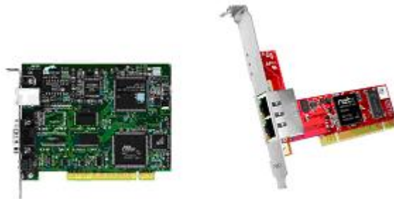
图1 CIF现场总线PC板卡
