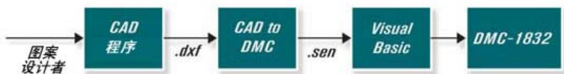
图 5. 控制软件方块图
