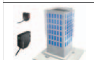
测量建筑缩微模型的振动
