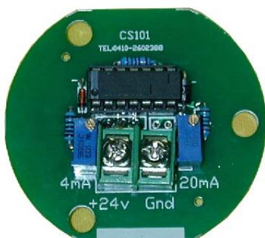
安装调试时，将 24V DC 电源的负极直接接到远传变送器内接线端子排的 Gnd 上，将电源的正极接入负载（如二次表）的电流输入端，负载（如二次表）的电流输出端引线接在远传变送器内接线端子排的 +24V 上，一般无需调校，若确需进行调校：
