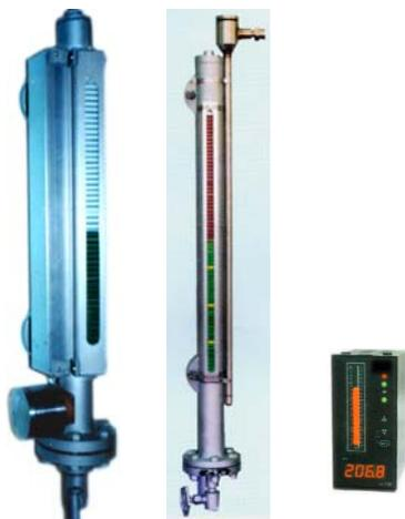
CFY-S/E 远传型磁浮翻转式双色液位计是由 CFY 磁浮翻转式双色液位计、YC 液位传感器及变送器、远传二次仪表组成。它除了具有一般磁浮翻转式双色液位计的现场液位指示功能外,还可将现场液位转换成 4~20mADC 的线性标准电流输出。该信号可远传至中心控制室用于实现液位的二次显示、高、低液位报警及液位联锁控制或 PID 调节等,亦可接入 DCS 系统。有防爆型及耐高温型可供选择。
