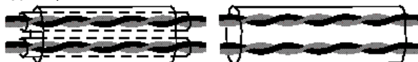
Obr. 22 Na levé straně dvojitý párový kabel s dvojitým stíněním, na levé straně vícepárový kabel s jednoduchým stíněním.
