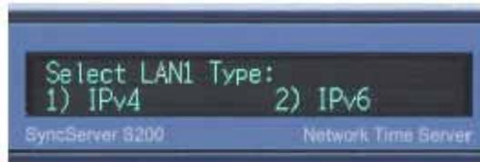
LED可快速的显示服务器状态信息，可以选择四种状态显示：网络连接状态、NTP运行状态、回应信息和报警信息。
