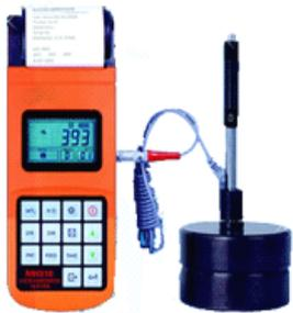
里氏硬度计 HLD610 依据里氏硬度测量原理，可以方便快捷地对多种金属材料进行测量，即刻显示硬度测量值的同时，可以在不同硬度制式间自由转换，可预先设置公差限，超出范围自动报警。该产品采用国际流行的热敏打印机与仪器集成为一体，并具工作安静、打印速度快，可以现场打印检测报告。依托稳定的低功耗 I C 集成电路，采用高对比度的段码液晶显示，操作简单、方便。七种异型冲击装置无需校准，自动识别。USB 接口传输，大容量存储，并附有 PC 机人性化数据处理软件及 USB 即插即用数据线缆。150 个小时的待机时间，内置镍氢可充电电池及充电控制电路，携带方便。特别适合工作现场和野外作业。
