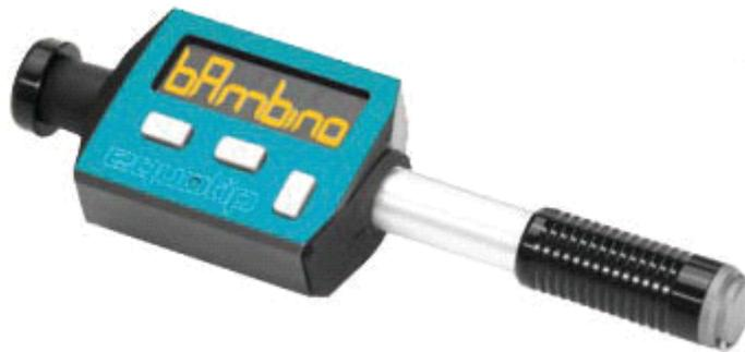
EQUOTIP BAMBINO 是一款使用简便的便携式硬度测试仪，可用于大多数金属的硬度测量。BAMBINO 结合了现代电子学和创新型冲击装置，提供了无与伦比的性价比。这款独立式测试仪无须其他显示装置、电缆或计算机硬件。有着轻巧而紧致设计的 BAMBINO 是质量控制、来料检验和全部产品测试的理想之选。其简便易操作的用户操作界面和实用的功能使得 BAMBINO 成为最符合人体工学的集成式回弹硬度测试仪。
