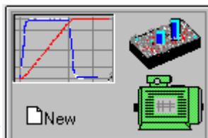
按下 **NEW** 按钮，打开“New Project”对话框，设置您的第一个应用轴号等于您的驱动器/电机轴 ID 号，初始值建议为 255，为驱动器默认轴 ID 号。
