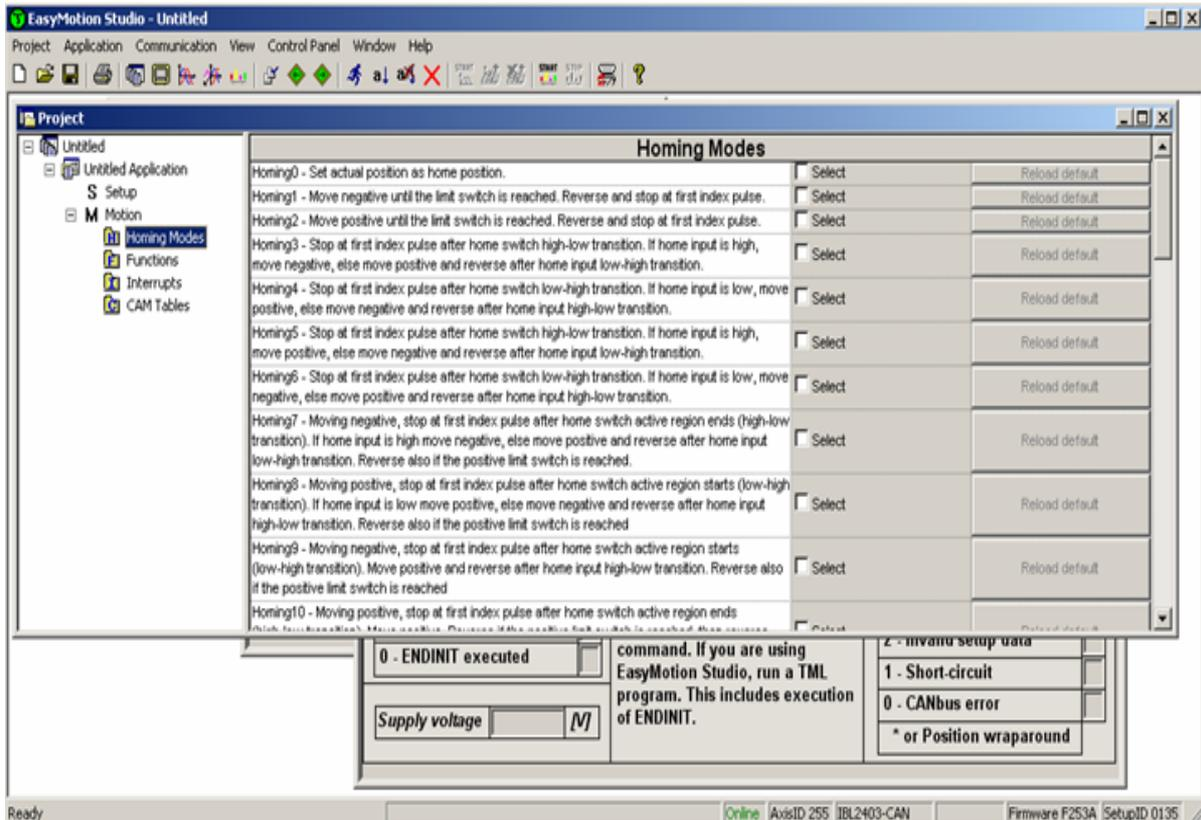
如果您点击 HomeX 程序, 在右侧您将看到执行它的 TML 函数, 回原点进程可根据您应用的需求用户化, 它调用的名字和方法能改变。
