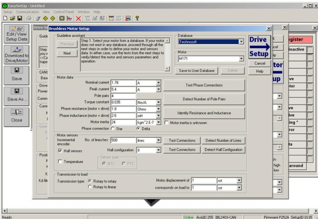
在 **Motor Setup** 对话框中您可以导入电机和传感器的数据，数据导入后将伴随一系列的测试，目的是检查驱动器的连接及检测或验证电机和传感器的部分参数。在 **Drive setup** 对话框中，您可以
