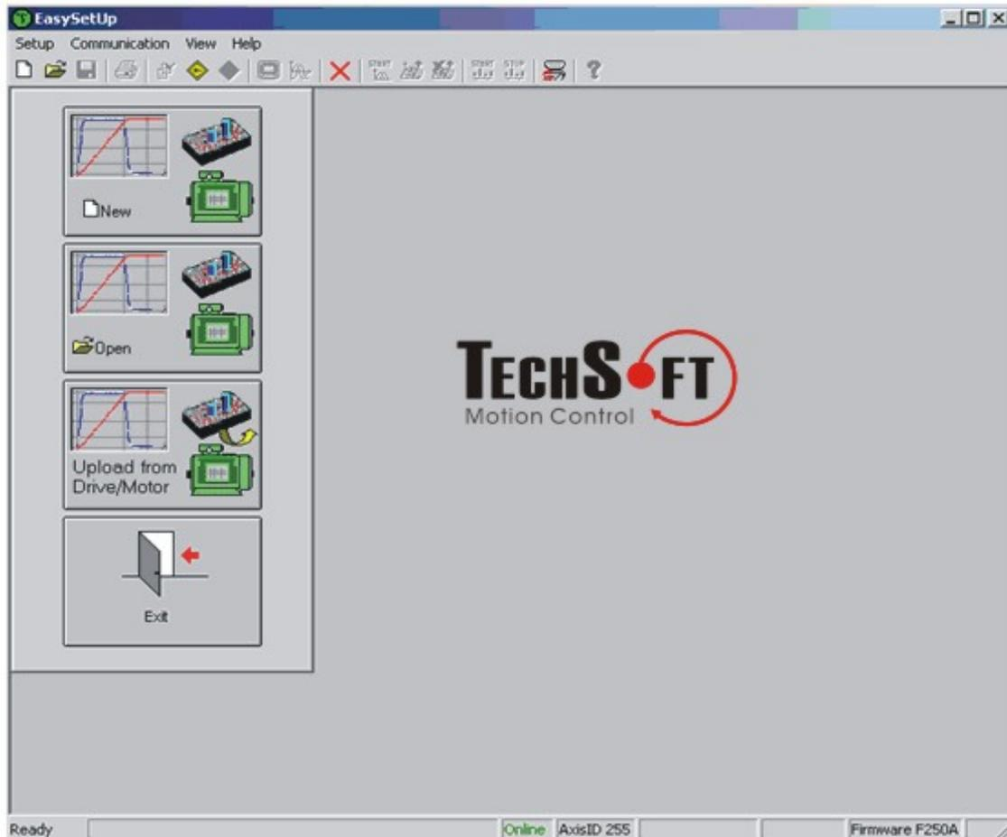
在选择上述任何一个操作前，您必须与您想试运行的驱动器建立通讯，用菜单 **Communication | Setup** 去检查/改变您的 PC 通讯设置，按下对话框中的 **Help** 按钮，这里您能找到关于如何去设置您的驱动器和如何去连接的详细信息，给驱动器上电，然后点击 **OK** 关闭 **Communication | Setup** 对话框，如果建立了通信，在 **EasySetup** 的状态栏中（底线）显示“**Online**”加上驱动器/电机轴的 ID 号和固件版本，否则将显示“**Offline**”及告诉您错误类型的通讯错误信息，在这种情况下返回 **Communication | Setup** 对话框，按下 **Help** 按钮并且检查故障。
