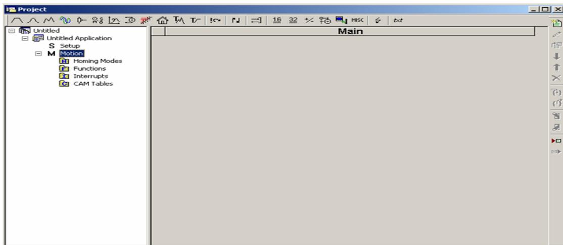
**Motion Wizard** 提供了用高级图形对话框编程所有运动序列后自动生成相应的 TML 指令，因此运用 **Motion Wizard** 您无需学习 TML 语言就几乎可以用所有的 TML 指令开发运动程序，一个 TML 程序包含了一个主程序，接下来可用的子程序：函数、中断服务进程（可用户化）和回原点过程程序，TML 程序也包含一个用于电子凸轮应用的凸轮表。
