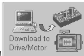
按下 **Download to Drive/Motor** 按钮以下载您的设置数据到驱动器/电机的 **EEPROM** 存储器中，以设置表形式存储。从现在开始，每次上电时该设置数据将被复制到驱动器/电机的 **RAM** 存储器中供运行期间使用，也可用 **Save** 将设置数据保存在您的电脑上并用于其他应用中，您也可以从驱动器/电机中上传完整的设置数据到 **PC**。
