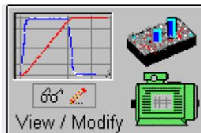
按下 **View/Modify** 按钮弹出两个设置对话框：**Motor Setup** 电机设置和驱动器设置 **Drive Setup**（与 **EasySetUp** 一样）通过他们您可以配置和参数化泰科智能驱动器，在 **Motor setup** 对话框中您可以导入电机和传感器数据，数据导入跟随一系列的测试为检查与电机连接或验证电机和传感器部分参数，在 **Drive setup** 对话框中，您可以为您的应用配置或参数化驱动器，在每一个对话框中您将找到 **Guideline Assistant**，它可以在整个导入和检查数据的过程中指导您完成。
