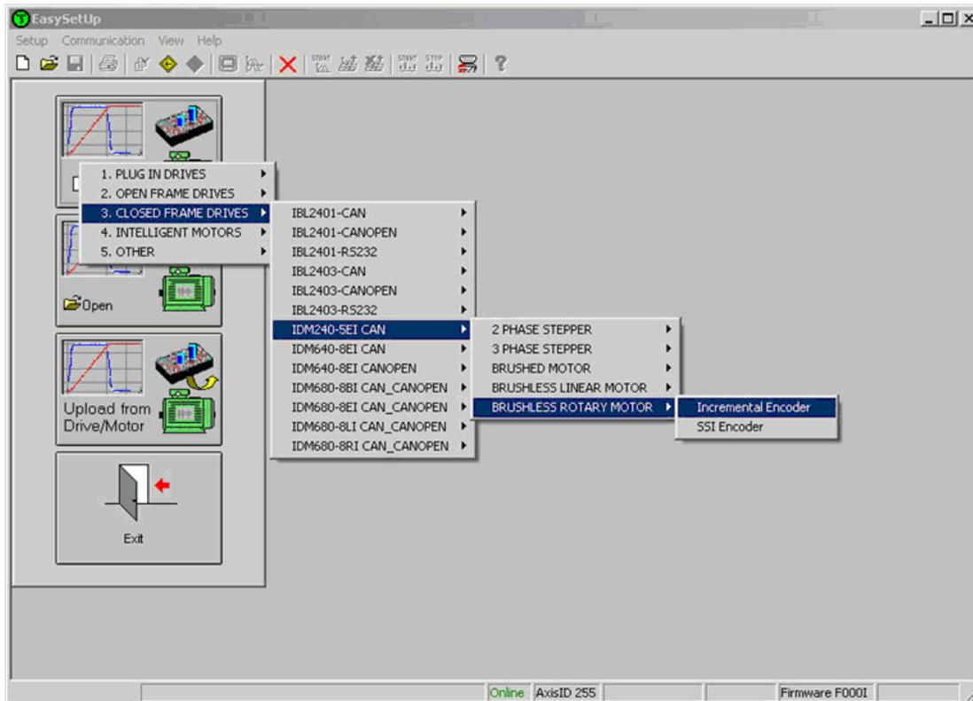
继续选择电机（比如无刷或有刷等）和反馈装置类型（如增量编码器，SSI 编码器等）。
