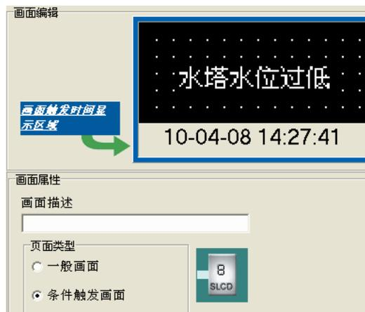
连接模拟比较器模块 B0002 与 SLCD，当 P1 的电压值小于 1V 时模拟比较器模块有输出，PLC 显示屏上显示报警信息。
