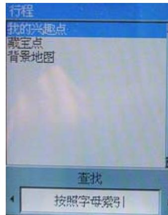
选择所要的兴趣点并按回车
