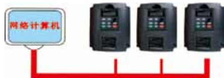
最多可连接 99 台变频器
