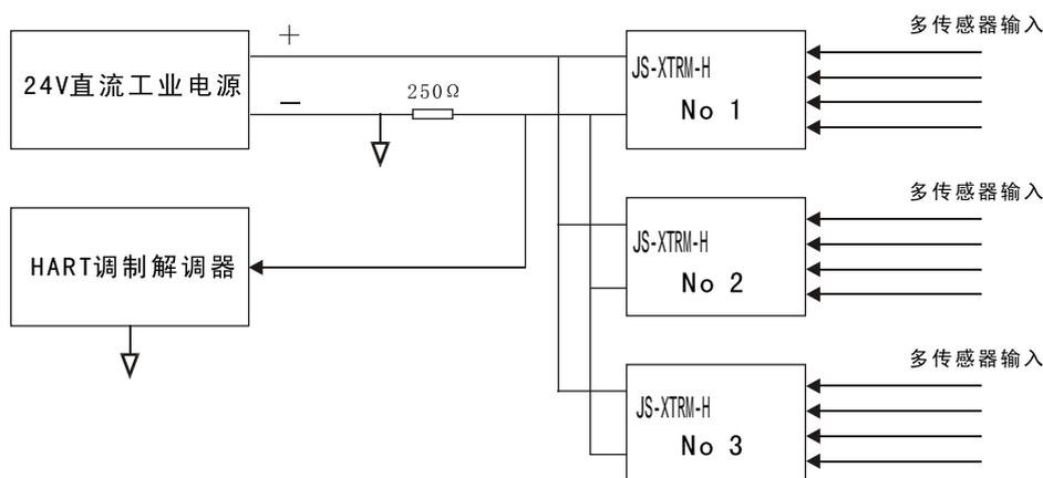
如上图所示，若干个JS-XTRM-H型变送器被并联在一组电流环上（理论值最多不能超过16个，通常是4-5个），HART调制解调器并联在250欧姆取样电阻上，与所有变送器实现双向通信。
