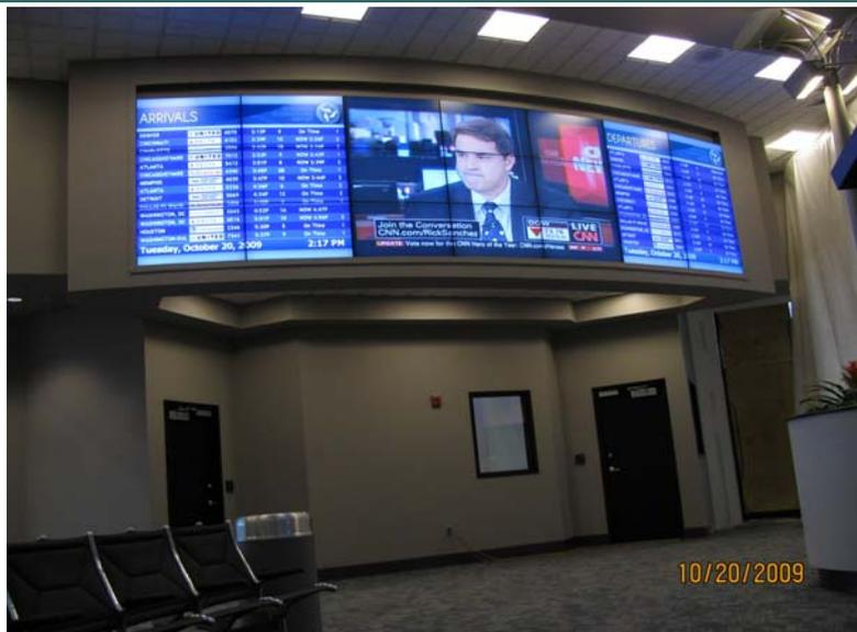
安装在美国Huntsville 机场3x7 21块LCD Matrix 显示屏，弧形拼接。用于显示航班信息、新闻节目以及任何的即时消息。
