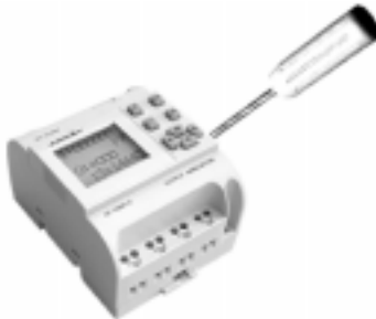
图 2.2 正确拆卸 LCD 的方法
