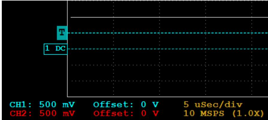
在正常模式下, 在等待触发期间, 您可以通过按“强制触发”按键强制触发。无论此时是否实际有触发事件发生, 这会致使触发事件发生。如果您想在不改变示波器设置的情况下看看信号到底是怎样的, 强制触发是个方便的办法。这个功能还有一个相应的[快捷键](#)。
