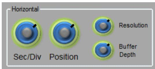
**横轴标尺系数：**该旋钮用于设置时基范围和示波器的采样率。请注意 采样率在主屏幕上扫描率之下显示，这样有助于迅速了解任何频谱混叠的含义。一般来说，最好确保采样率比目标主频率高出许多倍。比如说，如果您在观察一个 16KHz 的正弦波，那么要确保采样率大于等于 50KSPS。如果您在观察 16KHz 的矩形波，那么采样率应该更高。
